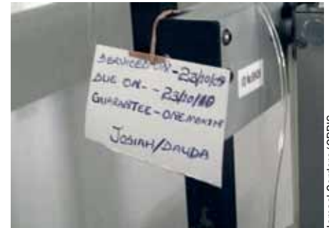
Figura 2. Una forma de hacer el seguimiento de las tareas de mantenimiento habituales es colocar una etiqueta en el equipo reparado o mantenido. Esta información debe archivarse en la central de registro de mantenimiento.
